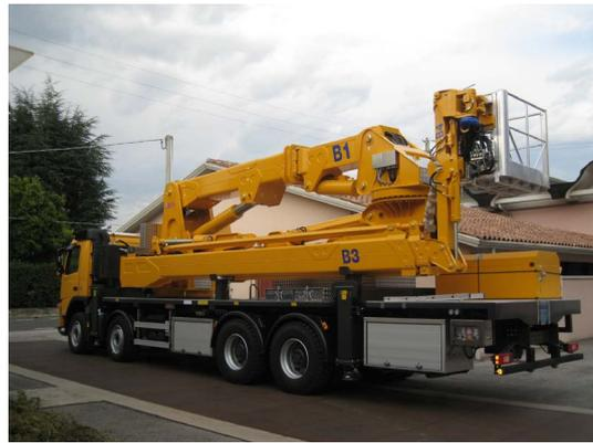
图 5：配备一流的部件，显著提高安全性。BARIN AB235L 配备堡盟无轴承编码器，可用于全球各地的桥梁检测。此外，粉尘、湿气、盐腐蚀等因素不会对编码器的设计造成任何影响。
