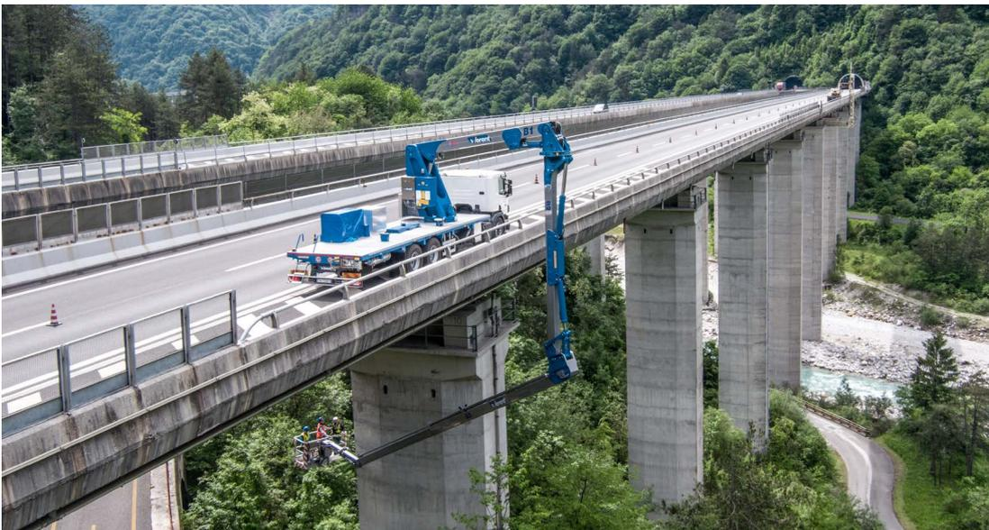
Figure1：安全第一：桥梁检测用移动机械需要在任何情况下都能确保安全作业。图为 BARIN AB20S 在意大利 A23 公路上进行高架桥检测。图片来源：BARIN
